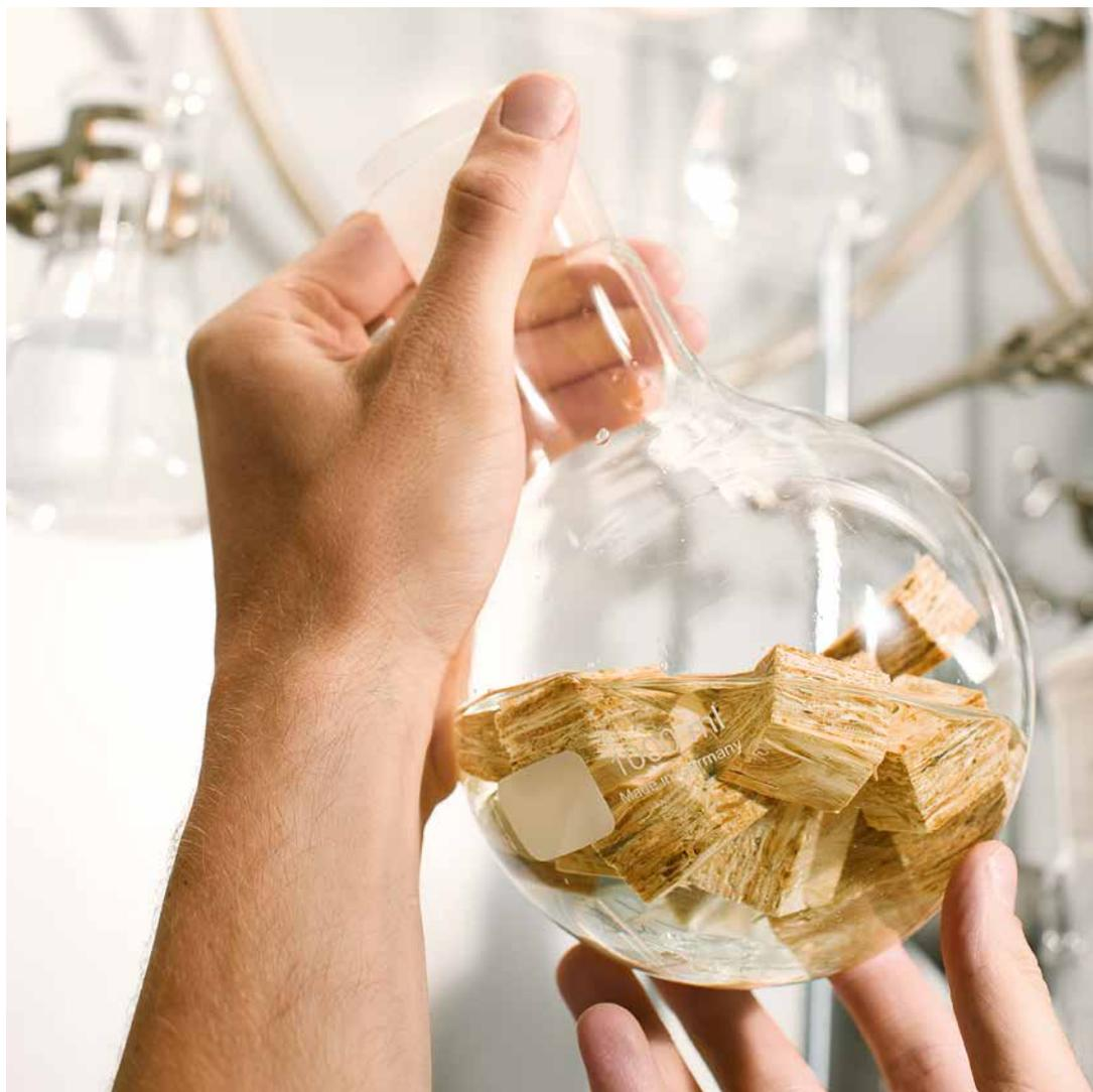
Древесина в лаборатории: при перфораторном тесте уровень содержания формальдегида в древесных плитах измеряется с помощью экстрагирования толуолом и последующего фотометрического определения.
