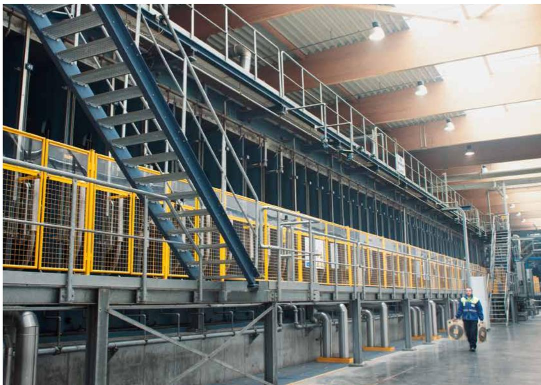
Пресс ContiRoll: центральный элемент каждого завода компании ЭГГЕР для изготовления необлицованных ДСП. Представленная здесь технологическая линия на предприятии в Гексхэме (Великобритания) имеет длину 48,5 м и ширину 2,6 м. С 2007 года она используется круглосуточно.
