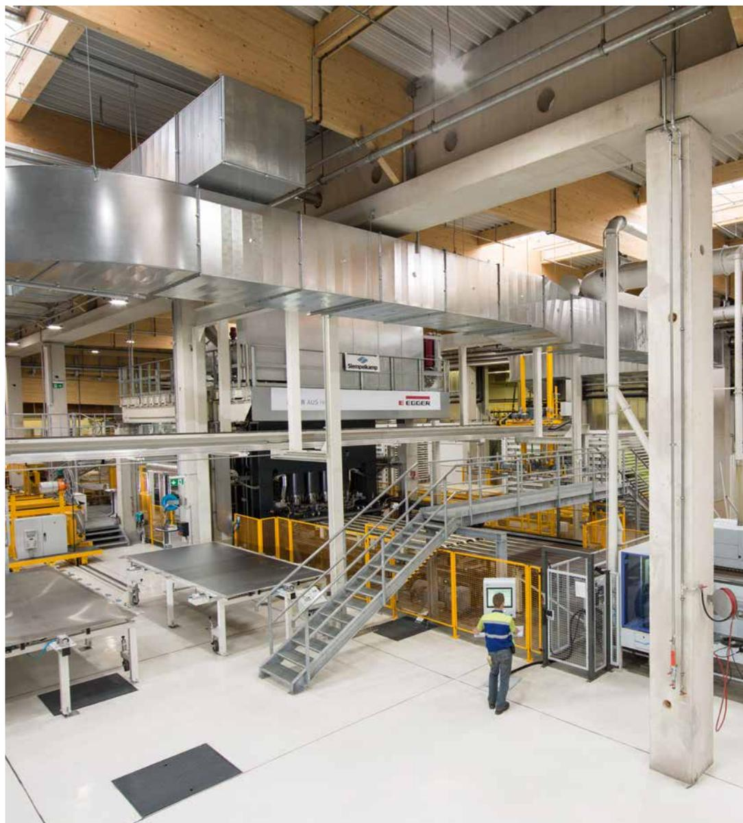
Применение высоких технологий: короткотактный пресс, введенный в 2013 году в эксплуатацию в Ст. Иоганне в Тироле (Австрия), первый подобного рода, применяется для нанесения покрытий с глубокими структурами и структурами серии «Синхронные поры» на поверхность плиты с обеих сторон, а также для прессования и облицовки компакт-плит и тонких плит.
