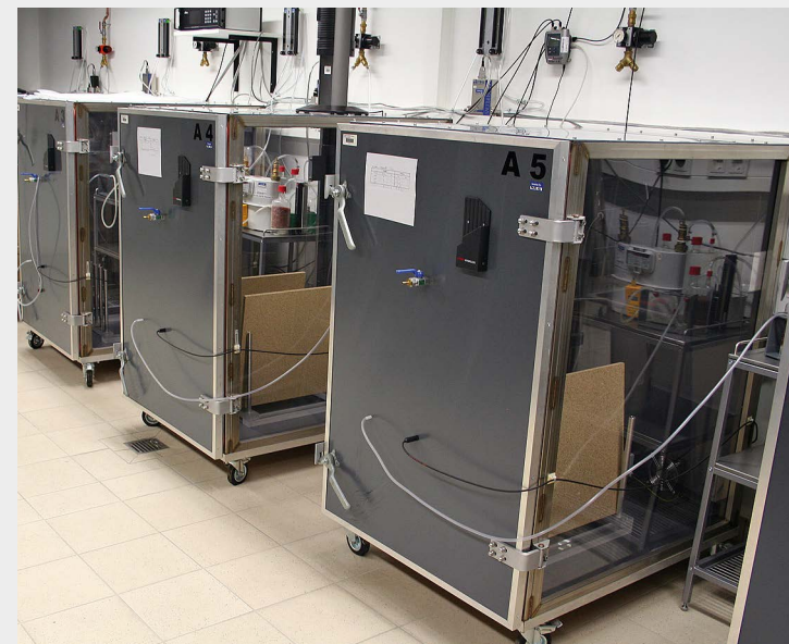
Испытательные камеры объемом 1 м³, установленные во Фраунгоферском институте по исследованию древесины им. Вильгельма Клаудица.
