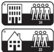
**Класс полезности [ISO 10874]** - благодаря своим параметрам изделие имеет высшие классы полезности - его можно использовать в интенсивно используемых домашних условиях - например, коридор, холл или кухня - 23 класс, а также в торговых помещениях с высокой проходимостью, например в офисах или торговых центрах - 34 класс.
