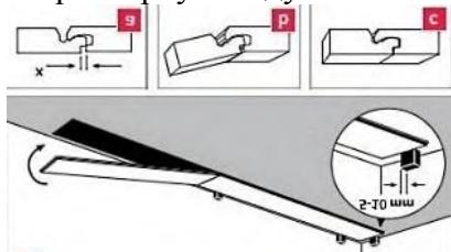
3. С помощью ножа и угольника отрезать последнюю доску ряда такого размера, чтобы между концом ряда и стеной остался 8-мм зазор.
