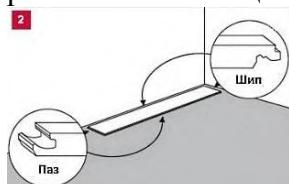
плитку стороной с шипом к стене (Рис. 2). 2. Уложить первый ряд, вставив 8-мм распорку между плиткой и стеной и убедившись, что короткие края соединены (Рис.3).
